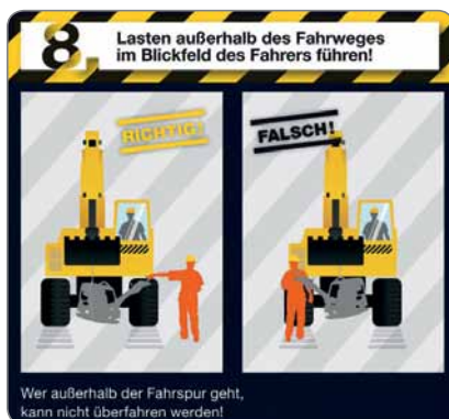
Diese Maßnahme schützt aber nicht vor einem versehentlichen Stolpern in die Fahrspur. Deshalb: Hände weg von Lasten bei fahrenden Maschinen!
